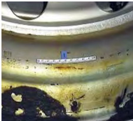
■亀裂部貫通写真
