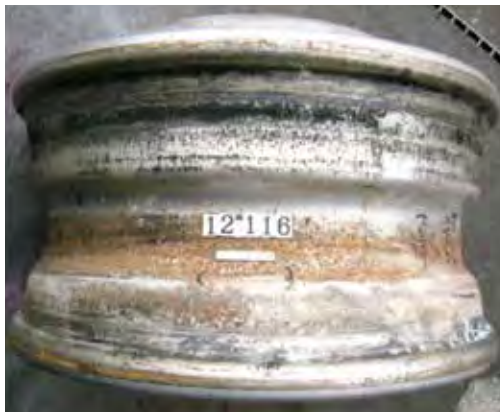
■リム腐食事例写真
